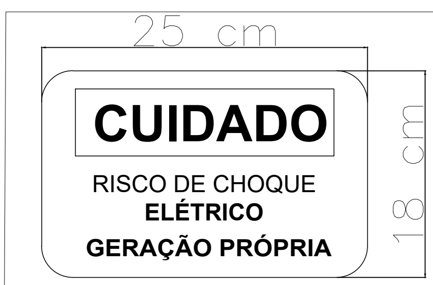
DETALHE DA PLACA DE ADVERTÊNCIA
