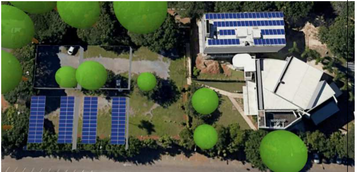
Figura 2 – Vista aérea do layout dos módulos fotovoltaicos da cobertura/laje e carports
